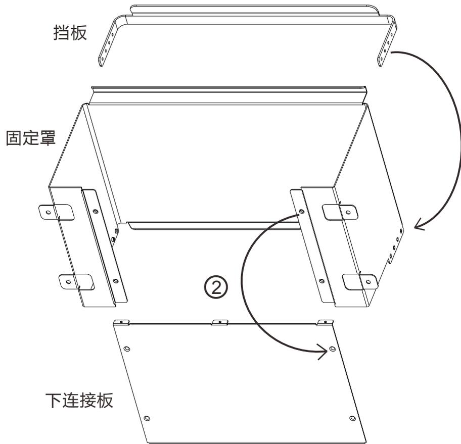
① 挡板装到固定罩上，并上好塑料圆柱手拧螺丝钉。
