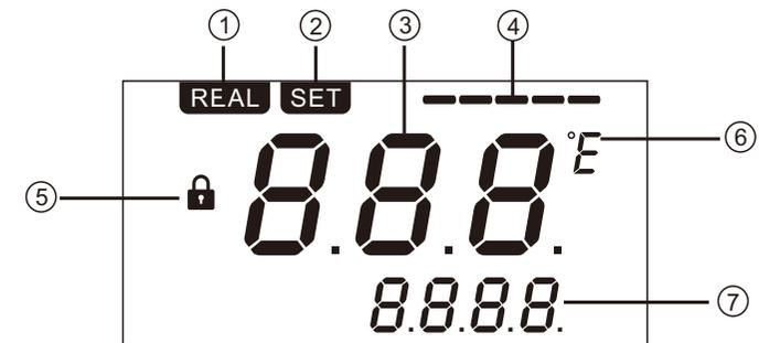
1. REAL(Real Temperature)：实际温度显示状态符号
